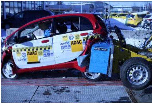
Choque por alcance según la norma americana a 80 Km/h
