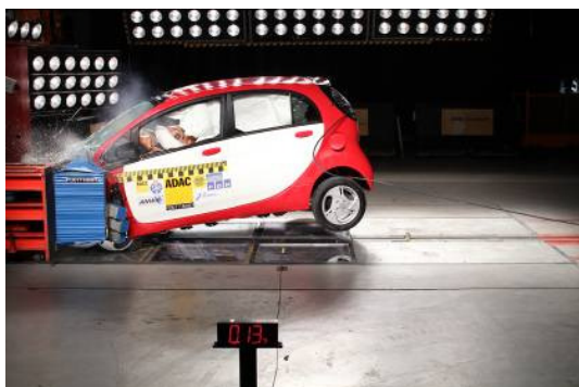
Crashtest frontal a 64 km/h según Euro NCAP
