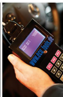
Paso 3 Introducir el nuevo valor de los km. al dispositivo
